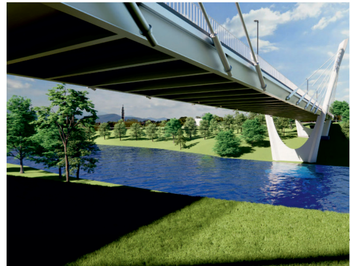
Render della campata del ponte sorretta da un sistema di 40 stralli ancorati alle due antenne laterali poggianti fuori dall'alveo del fiume.
